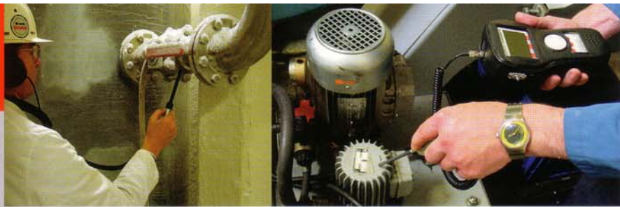
Abbildungen (oben) Verschleiß-Untersuchung bei Wälz- und Gleitlager mit Körperschallsonde / Ortung von Leckagen mit Luftschallsonde
