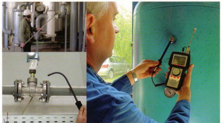
Abbildungen / unten hohe Reichweite mit Teleskopstange (Länge max. 3 m), große Mobilität mit biegsamer Sonde, Multifunktionalität: Ortung von Leckagen und Temperaturmessung
