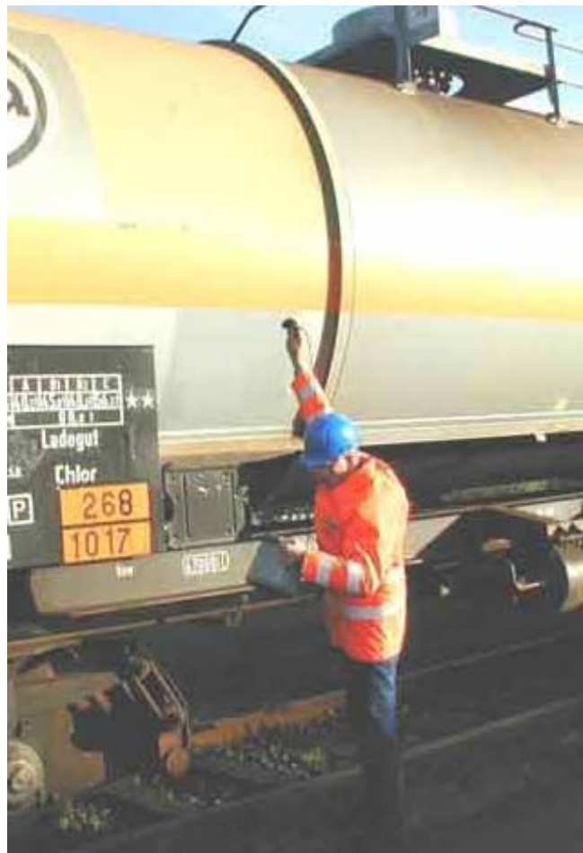
Überfüllkontrolle bei der Bahn
