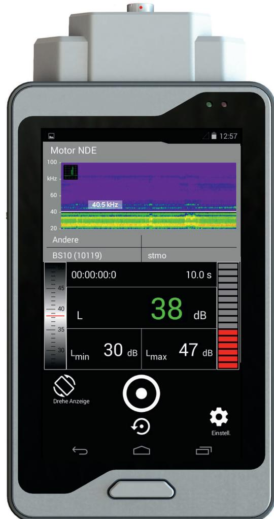
Das digitale Prüfgerät erfasst zunächst über den Sensor hochaufgelöste Rohdaten mit 256 kHz. Die Messergebnisse werden dann in Form von Kennwerten (z. B. Pegelwerte) und visuell im Spektrogramm dargestellt. Der Instandhalter kann anhand dieser Angaben bereits vor Ort eine erste Aussage über den Zustand der Betriebsmittel im Kraftwerk treffen.
