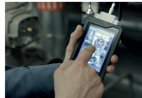
Nach der Aufnahme von Temperatur und Ultraschall werden Fotos, Sprachmemos und Kommentare zu jedem Prüfpunkt hinzugefügt.
