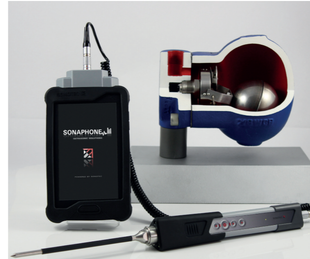
Bei der Prüfung der Kondensatableiter wurden die Energie-Scouts mit Technik aus dem Hause SONOTEC unterstützt. Arbeitet der Kondensatableiter korrekt oder ist er defekt? Das digitale Ultraschallprüfgerät SONAPHONE lieferte die Antwort auf diese Frage.
