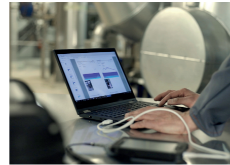
Die Auswertung der Kondensatableiter kann vor Ort oder im Anschluss am PC mit der DataViewer Software erfolgen. Außerdem werden der Export als CSV und PDF zur Dokumentation unterstützt.
