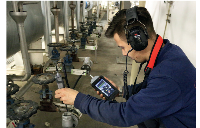
Temperaturmessung mit kombinierten Körperschall- und Temperatursensor BS20
