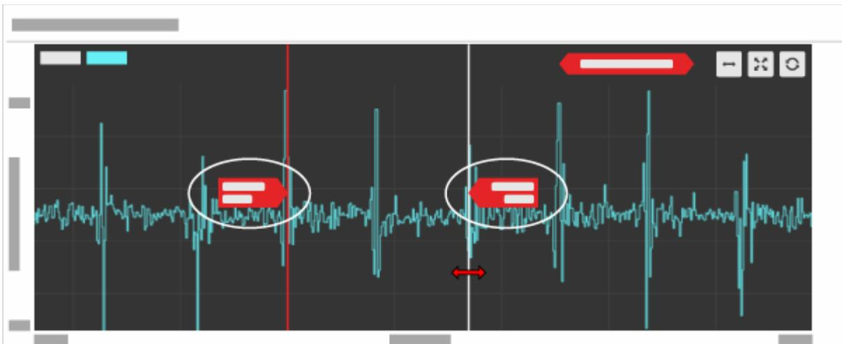
→ In der Kopfzeile des Zeitsignals werden die Zeitdifferenz und die entsprechende Wiederholfrequenz für den Bereich zwischen den beiden Zeit-Cursors angezeigt.
