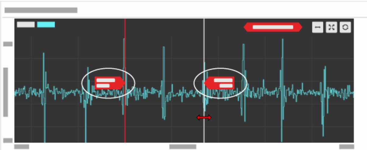
→ In der Kopfzeile des Zeitsignals werden Zeit und Frequenz für den Bereich zwischen den beiden Zeit-Cursors angezeigt.
