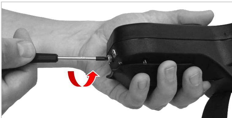
3. Batteriefach nach unten kippen und aus dem Gerät ziehen.
