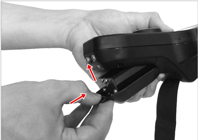
7. Arretierschraube des Batteriefaches wieder festziehen.
