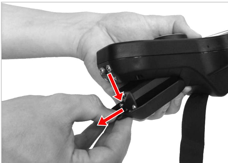
4. Batterien aus dem Batterieblock entnehmen.
