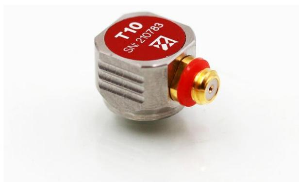
Die Körperschallsonde T10 wird für die Zustandsüberwachung von Maschinen, Anlagen und Prozessen verwendet, bei denen nachweisbarer Körperschall im Ultraschallbereich entsteht. Veränderungen der Schallsignale weisen auf eine Zustands- und/oder Prozessänderung im Prüfobjekt hin. Die Detektion dieser Veränderungen bildet die Grundlage für die Zustandsüberwachung in der vorbeugenden Instandhaltung.
