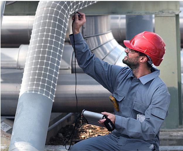
Schäden durch Korrosion und Erosion gehören zu den häufigsten Sicherheitsrisiken und sind Ursache für Produktionsausfälle in Industrieanlagen wie Raffinerien, Rohrleitungsnetzen, Chemiewerken, Offshore-Plattformen, Lagertanks usw. Um diese Anlagen zu erhalten und Gefahren zu vermeiden, werden Ultraschall-Dickenmessungen in der Regel häufig an vordefinierten Prüfrastern aufgezeichnet.
