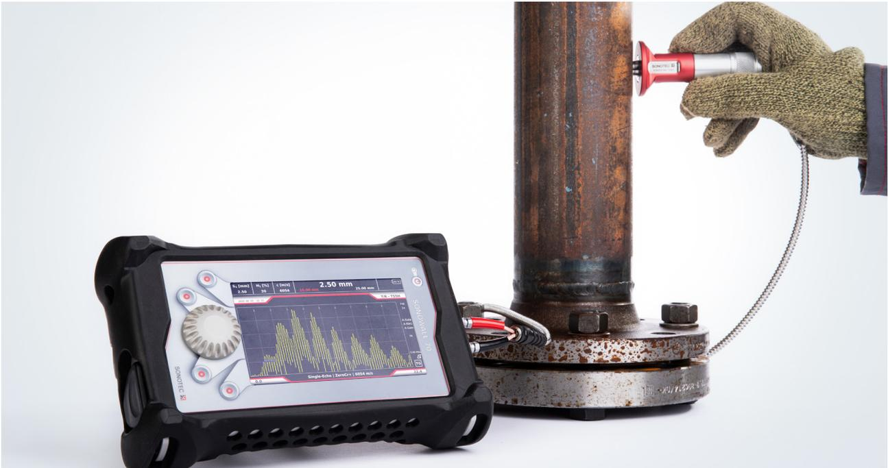
Hochtemperatur-Korrosionsprüfung mit SONOWALL 70 und SONOSCAN TS5H Ultraschallprüfset
