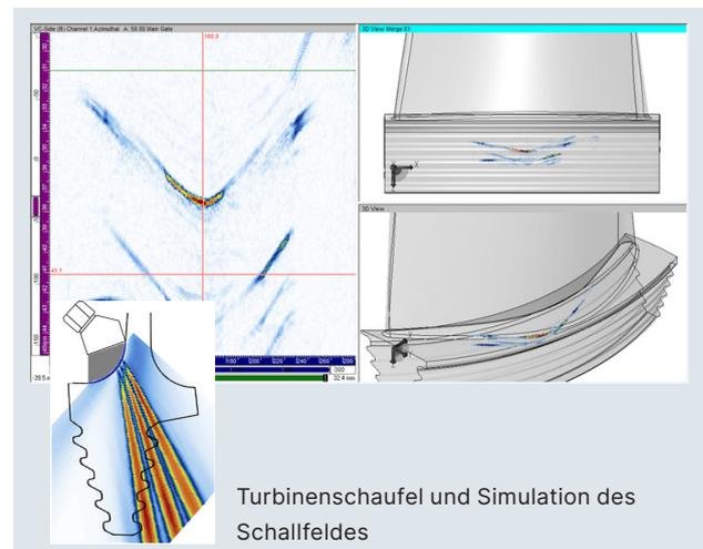
Basierend auf der räumlichen Geometrie der Schaufeln und auf den Ergebnissen der 3D-Ultraschallsimulation, wurde die Grundkonstruktion des Scanners so angepasst, dass eine korrekte Positionierung auf der Schaufeloberfläche, im Schaufelradius und an der Befestigung möglich ist. Die Positionierung des Prüfkopfes und die Durchführung des Scans dauert inklusive der Datenvalidierung üblicherweise nicht länger als fünf Minuten.
