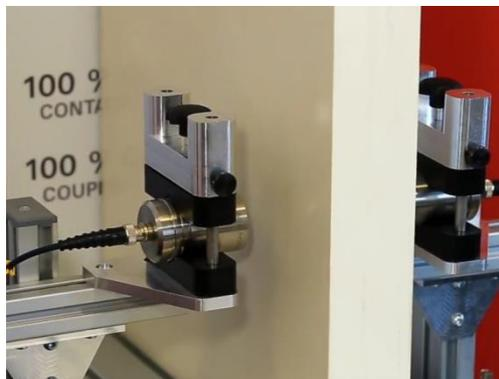
Abb. 6: Prüfaufbau mit 75 kHz Wandlern für die Messung an einer 80 mm Dämmplatte
